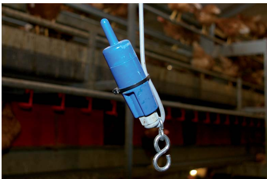
De voelers hangen midden in de stal, zodat ze de luchtstroom beter meten.
