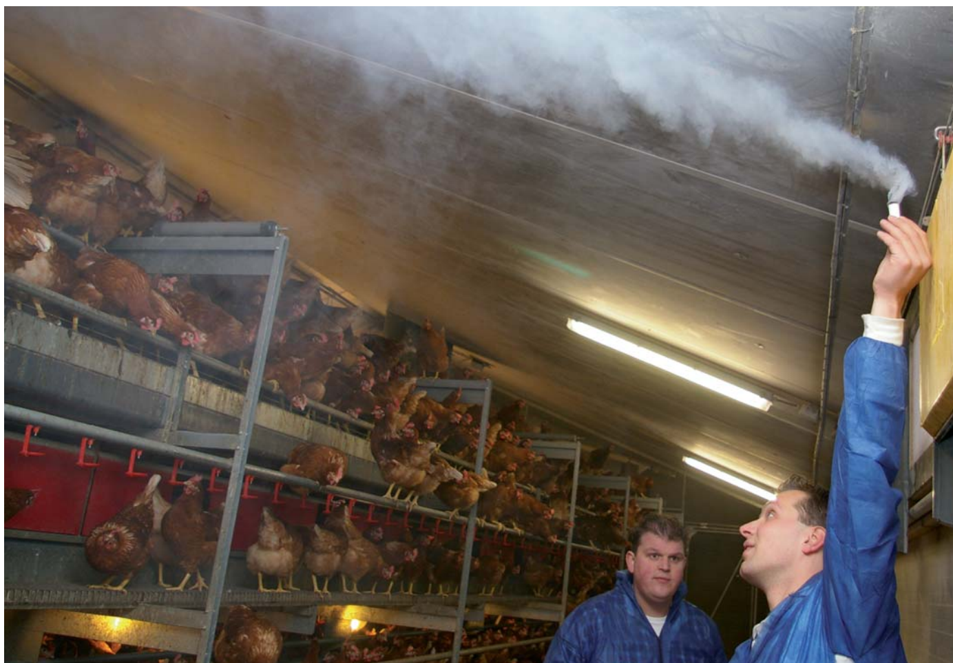
William de Koning van Veko Ventilatie laat zien hoe de lucht zich verplaatst na het afdekken van de kier.
